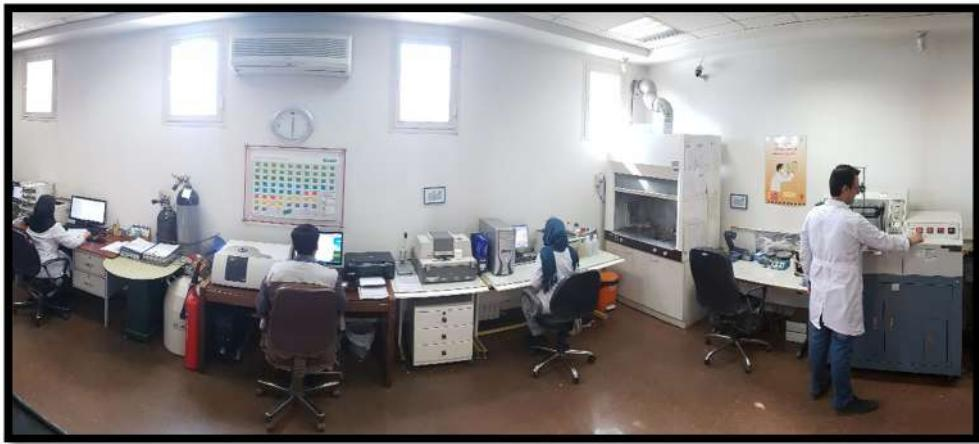
طیف بسیار گسترده‌ای از آزمون‌های مواد پلیمری روی ترموپلاست‌ها، ترموپلاست‌ها و الاستومرها، از آنالیز مواد گرفته تا خواص مکانیکی و فیزیکی مواد پلیمری در این آزمایشگاه قابل انجام است.
