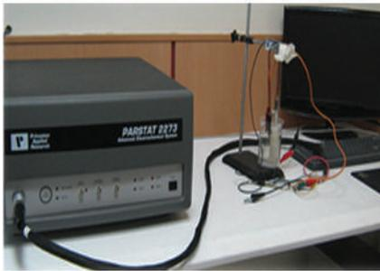
آزمایشگاه خوردگی مرکز پژوهش متالورژی رازی امکانات انجام آزمون‌های "الکتروشیمیایی" بر اساس استانداردهای ASTM G1 & G102 و G3 با استفاده از دستگاه پتانسیواستات EG&G مدل PARSTAT 2273 را دارا می‌باشد. در این آزمون‌ها به بررسی رفتار خوردگی فلزات، آلیاژها و نیز پوشش‌های فلزی و آلی پرداخته می‌شود.
